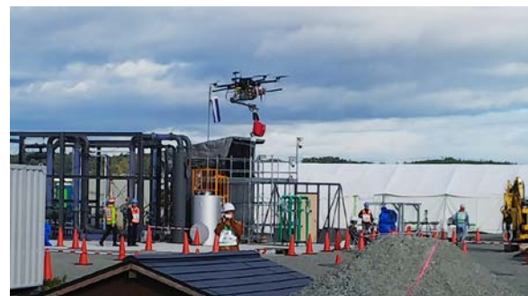
ロボットアームにターニケットを入れた 救急袋をぶらさげて被災者に届けるドローン
